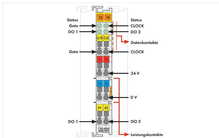
Questo contatore è impiegato nella misurazione della frequenza. Il contatore misura il periodo d'impulso del segnale da 24 V all'ingresso CLOCK e poi lo converte in un valore di frequenza.
