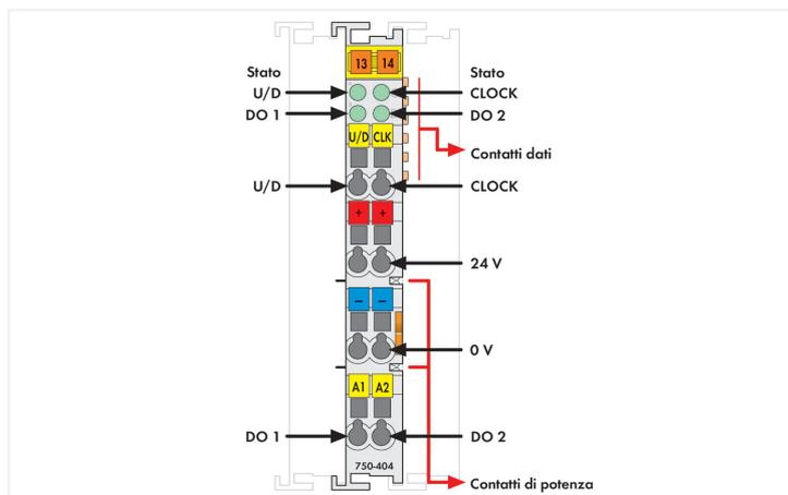
Questo contatore registra impulsi binari a 24 V e trasmette lo stato del contatore al sistema del fieldbus.
