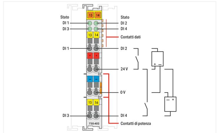
Questo modulo di ingresso digitale riceve i segnali di controllo dai dispositivi sul campo (ad es. sensori). Ogni modulo d'ingresso è dotato di un filtro per la soppressione dei disturbi. Campo e sistema sono separati galvanicamente.
