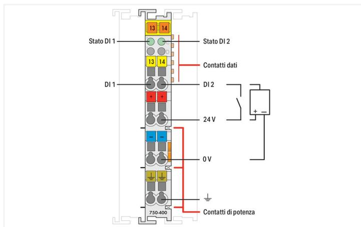
Questo modulo di ingresso digitale riceve i segnali di controllo dai dispositivi sul campo (ad es. sensori). Ogni modulo d'ingresso è dotato di un filtro per la soppressione dei disturbi. Campo e sistema sono separati galvanicamente.
