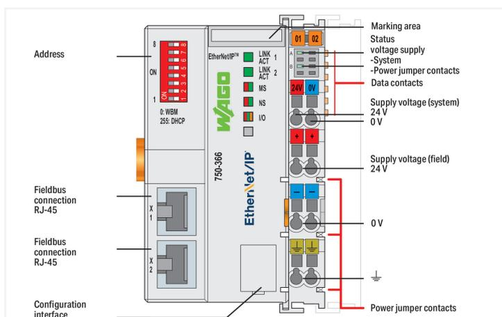
L'accoppiatore fieldbus EtherNet/IP™ 750-366 collega il sistema l'accoppiatore al sistema fieldbus EtherNet/IP™.
