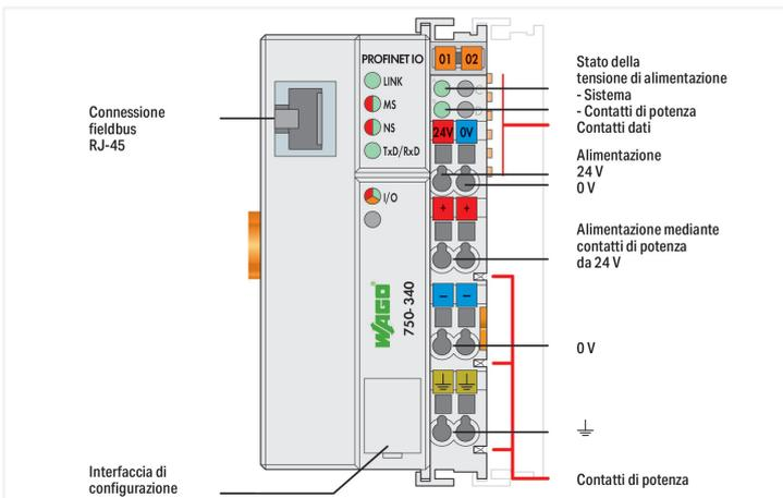
Questo accoppiatore fieldbus collega il WAGO-I/O-SYSTEM al PROFINET IO, lo standard d'automazione ETHERNET industriale aperto. L'accoppiatore fieldbus rileva tutti i moduli I/O collegati e crea un'immagine di processo locale. Questa immagine di processo può comprendere un sistema misto di moduli analogici (trasferimento dati word per word) e digitali (trasferimento dati bit per bit). L'accoppiatore fieldbus è integrato nell'applicazione come un dispositivo PROFINET IO.
