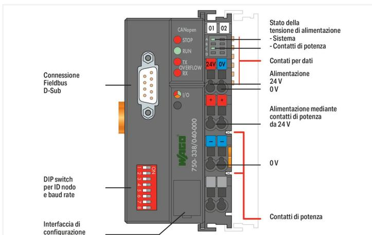
Questo accoppiatore fieldbus collega il sistema I/O della WAGO come uno slave al fieldbus CANopen. I dati vengono trasmessi tramite PDO e SDO. L'accoppiatore fieldbus rileva tutti i moduli I/O collegati e crea un'immagine di processo locale. I dati dei moduli speciali e analogici sono inviati mediante word e/o byte, i dati digitali sono inviati bit per bit.
