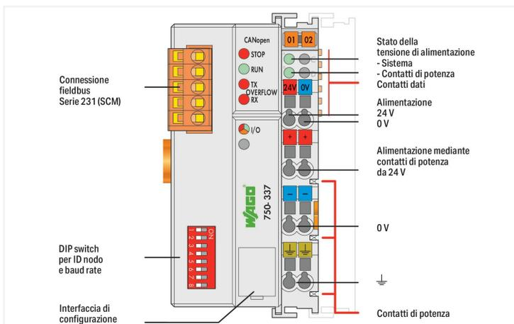
Questo accoppiatore fieldbus collega il sistema I/O della WAGO come uno slave al fieldbus CANopen. I dati vengono trasmessi tramite PDO e SDO.
