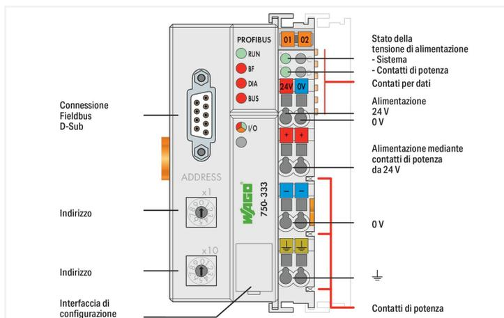
L'accoppiatore fieldbus 750-333 esegue la mappatura dei dati periferici di tutti i moduli I/O del WAGO I/O System sul PROFIBUS DP.
