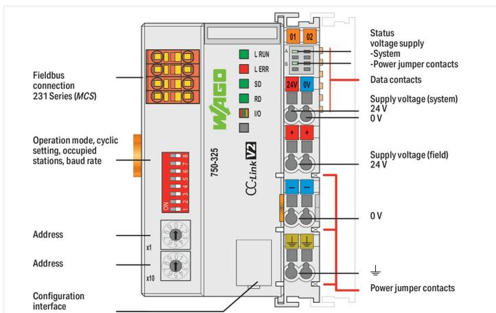
Questo accoppiatore fieldbus collega il WAGO I/O System come uno slave al fieldbus CC-Link. L'accoppiatore fieldbus supporta il protocollo CC-Link delle versioni V1.1 e V2.0.
