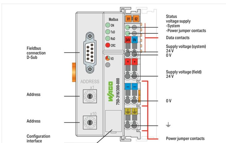
Questo accoppiatore fieldbus collega il WAGO-I/O System come uno slave al fieldbus MODBUS.
