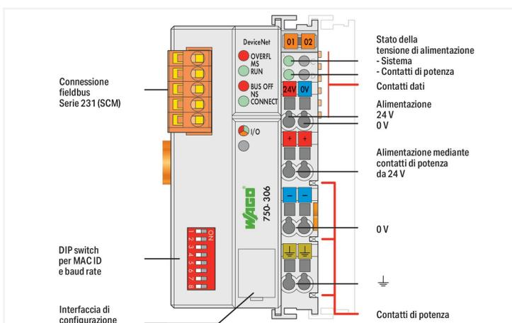
Questo accoppiatore fieldbus collega il WAGO-I/O System come uno slave al fieldbus DeviceNet.
