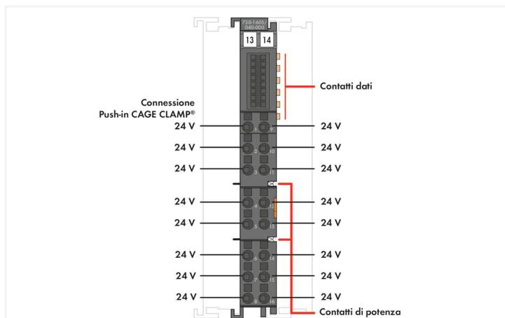
Questo modulo di connessione lato campo fornisce 24 V agli ingressi, ad esempio in combinazione con il modulo d'ingresso a 16 canali 750-1405/040-000.
