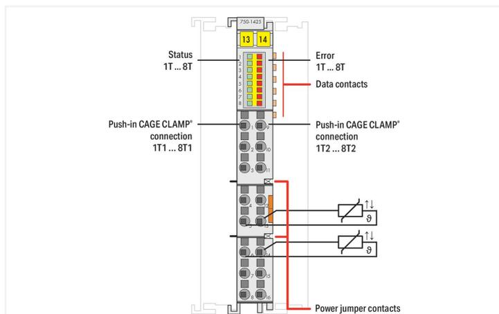
Il modulo PTC, largo solo 12 mm, è dotato di otto canali per collegare i termistori PTC, in conformità alle norme DIN 44081 e DIN 44082, per il monitoraggio termico (protezione da sovraccarico) di motori, macchine, cuscinetti ecc.
