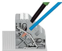
Inserimento dei conduttori flessibili mediante cacciavite (lama di 5,5 mm).
