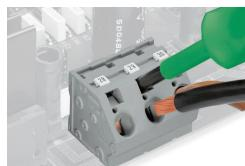
Inserimento/rimozione di un conduttore tramite cacciavite di 5,5 mm: serie 745, 16 mm<sup>2</sup>.
