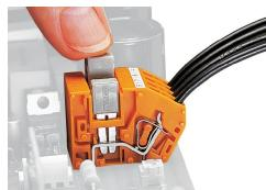
Collegamento a ponte con ponticelli orizzontali.
