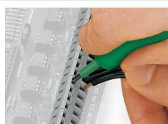
Inserimento di un conduttore tramite cacciafile di 3,5 mm.
