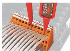
Test tramite l'area di contatto sopra i conduttori.
