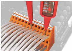
Test tramite l'area di contatto sopra i conduttori.
