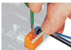
Rimozione di un conduttore tramite pulante.
