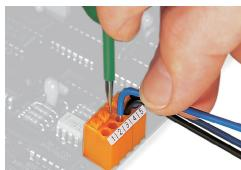
Rimozione di un conduttore tramite pulante.
