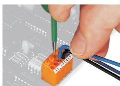
Rimozione di un conduttore tramite pulante.
