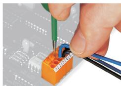
Rimozione di un conduttore tramite pulsante.
