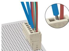
Test tramite punta di test di Ø 1 mm (735-500), – connessione CAGE CLAMP® – contatto diretto.
