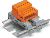
Utilizzo di due adattatori di montaggio per guida DIN 35 (209-137) per 3 o più poli; distanza tra i due adattatori di montaggio: massimo 7 poli
