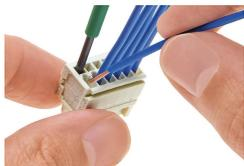
Inserimento del conduttore mediante cacciavite da 2,5 x 0,4 mm: azionamento di CAGE CLAMP® parallelamente rispetto all'ingresso del conduttore.
