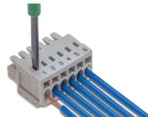
Inserimento di un conduttore mediante cacciavite da 2,5 x 0,4 mm: azionamento di CAGE CLAMP® perpendicolarmente rispetto all'ingresso del conduttore.
