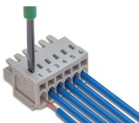
Inserimento di un conduttore mediante cacciavite da 2,5 x 0,4 mm: azionamento di CAGE CLAMP® perpendicolarmente rispetto all'ingresso del conduttore.
