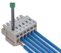
Inserimento di un conduttore mediante cacciavite da 2,5 x 0,4 mm: azionamento di CAGE CLAMP® perpendicolarmente rispetto all'ingresso del conduttore.
