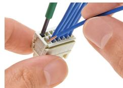
Inserimento del conduttore mediante cacciavite da 2,5 x 0,4 mm: azionamento di CAGE CLAMP® parallelamente rispetto all'ingresso del conduttore.
