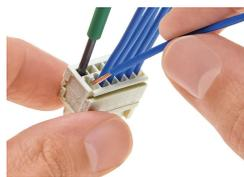
Inserimento del conduttore mediante cacciavite da 2,5 x 0,4 mm: azionamento di CAGE CLAMP® parallelamente rispetto all'ingresso del conduttore.
