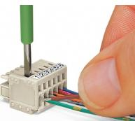
Inserimento del conduttore mediante cacciavite da 2,5 x 0,4 mm: azionamento di CAGE CLAMP® perpendicolarmente rispetto all'ingresso del conduttore.
