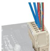
Test tramite punta di test di Ø 1 mm (735-500), contatto diretto.
