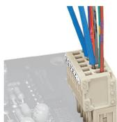
Test tramite punta di test di  $\varnothing$  1 mm (735-500), contatto diretto.
