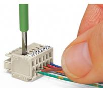
Inserimento del conduttore mediante cacciavite da 2,5 x 0,4 mm: azionamento di CAGE CLAMP® perpendicolarmente rispetto all'ingresso del conduttore.
