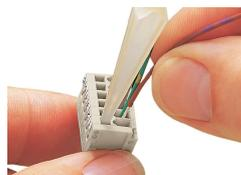
Connessione del conduttore mediante utensile (733-191)
