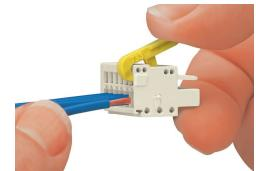
Inserimento del conduttore mediante cacciavite da 2,5 x 0,4 mm: azionamento di CAGE CLAMP® perpendicolarmente rispetto all'ingresso del conduttore.
