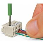
Inserimento del conduttore mediante cacciavite da 2,5 x 0,4 mm: azionamento di CAGE CLAMP® perpendicolarmente rispetto all'ingresso del conduttore.
