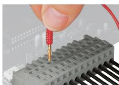
Test: connettore femmina con CAGE CLAMP®
