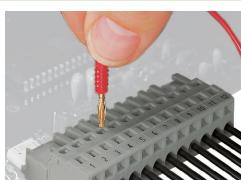
Test: connettore femmina con CAGE CLAMP®
