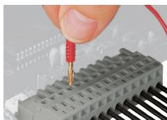
Test: connettore femmina con CAGE CLAMP®
