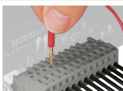
Test: connettore femmina con CAGE CLAMP®
