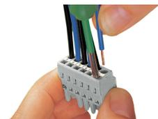
Inserimento del conduttore mediante cacciavite da 3,5 mm: azionamento di CAGE CLAMP® parallelamente rispetto all'ingresso del conduttore.
