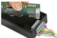
Connettore femmina angolato - utilizzato come connettore passaparete; le porte di connessione e gli slot operativi sono sistemati all'esterno della scatola - spessore del pannello fino a 2 mm.
