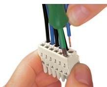
Inserimento del conduttore mediante cacciavite da 3,5 mm: azionamento di CAGE CLAMP® parallelamente rispetto all'ingresso del conduttore.
