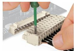
Inserimento di un conduttore mediante cacciavite da 3,5 mm: azionamento di CAGE CLAMP® perpendicolaramente rispetto all'ingresso del conduttore.
