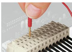
Test in perpendicolare all'ingresso del conduttore con spina di prova di 2 o 2,3 mm Ø – connettore femmina con CAGE CLAMP® – tramite porte di test integrate
