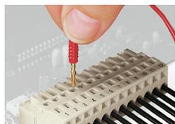
Test in perpendicolare all'ingresso del conduttore con spina di prova di 2 o 2,3 mm Ø - connettore femmina con CAGE CLAMP® - tramite porte di test integrate
