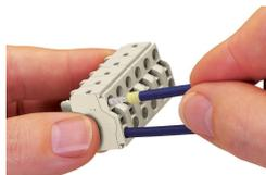
I conduttori rigidi  $\geq 0,5 \text{ mm}^2$  (20 AWG) e i conduttori flessibili con boccia crimpata possono venire connessi premendoli direttamente nell'unità. Delle aperture per test integrate consentono un contatto diretto con la barra di corrente tramite punte di prova sia in direzione orizzontale che verticale.
