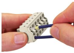
I conduttori rigidi ≥ 0,5 mm<sup>2</sup> (20 AWG) e i conduttori flessibili con boccola crimpata possono venire connessi premendoli direttamente nell'unità. Delle aperture per test integrate consentono un contatto diretto con la barra di corrente tramite punte di prova sia in direzione orizzontale che verticale.
