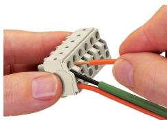
L'azionamento del Push-in CAGE CLAMP® è semplice, veloce e identico a quello del CAGE CLAMP®. Il cacciavite viene inserito completamente nell'apertura di azionamento tenendo il Push-in CAGE CLAMP® aperto. Dopo aver inserito il conduttore nell'unità di connessione e aver ritirato il cacciavite il conduttore risulta saldamente bloccato. I conduttori rigidi e flessibili < 0,5 mm<sup>2</sup> (20 AWG) vengono connessi e rimossi usando un cacciavite.
